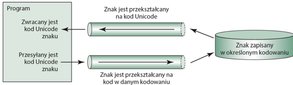
RYСУNEK 34.11. Kodowanie w pliku może być inne niż kodowanie używane w programie
