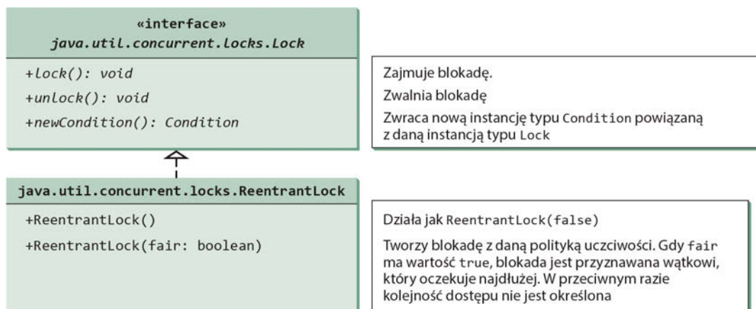
RYSUNEK 32.13. Klasa ReentrantLock implementuje interfejs Lock i reprezentuje blokadę
